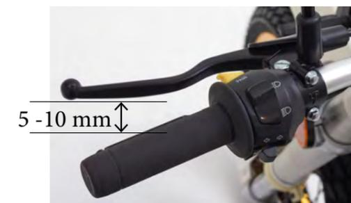
Mutter (1) lösen und Spannring des Hebels (2) ganz im Uhrzeigersinn drehen. Lösen Sie die Kontermutter des Seilspannrings (5), bevor Sie den Ring (4) in eine Richtung und dann in die andere Richtung drehen, bis das Spiel im Hebel ca. 4 mm erreicht. Zur Feinjustierung kann optional der Hebeleinstellring (2) verwendet werden. Nach der Einstellung die Kontermutter (1) und den Ring (5) wieder festziehen und mit der Gummimanschette (3) umwickeln.
