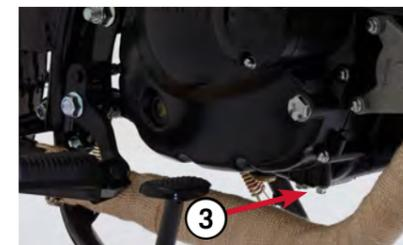
4. Ziehen Sie die Ablassschraube fest und füllen Sie den Öltank mit der erforderlichen Ölmenge, bevor Sie den oberen Stopfen vorsichtig anziehen.
