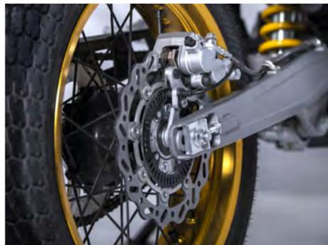
Entfetten Sie die hintere Bremsscheibe in regelmäßigen Abständen, um jederzeit eine optimale Bremsqualität zu gewährleisten.
