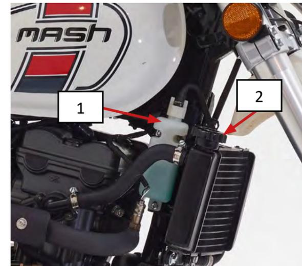
Auf der rechten Seite des vorderen Endes des Kraftstofftanks des Fahrzeugs ist ein Nachfüllbehälter ① und der Kühlerverschluss ② angebracht. Der Kühlmittelnachfüllbehälter ① ist mit Füllstandsskalen im Behälter versehen, der Füllstand muss zwischen oberer und unterer Skala liegen. Wenn der Wasserstand unter der Mindestgrenze liegt, öffnen Sie den Kühlerdeckel ②, geben Sie spezielles Frostschutzmittel in den Nachfüllbehälter, fügen Sie kein Leitungswasser oder andere Flüssigkeiten hinzu.
