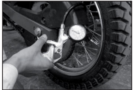
Luftdruck messen am Hinterrad
