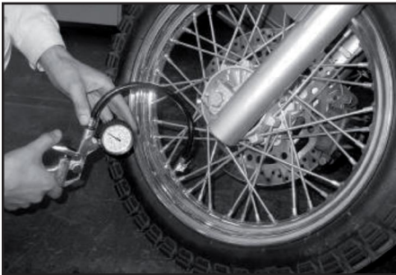
Luftdruck messen am Vorderrad
